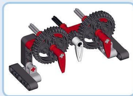
Рис. 11.9. Зубчатая передача с колесами 36Т (слева), 12Т (в центре) и второго 36Т (справа)
